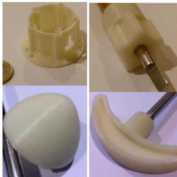
Figura 9: Elementos fabricados por FDM
